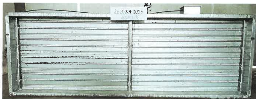
照片 2 耐腐蚀性试验后试件叶片关闭状态
