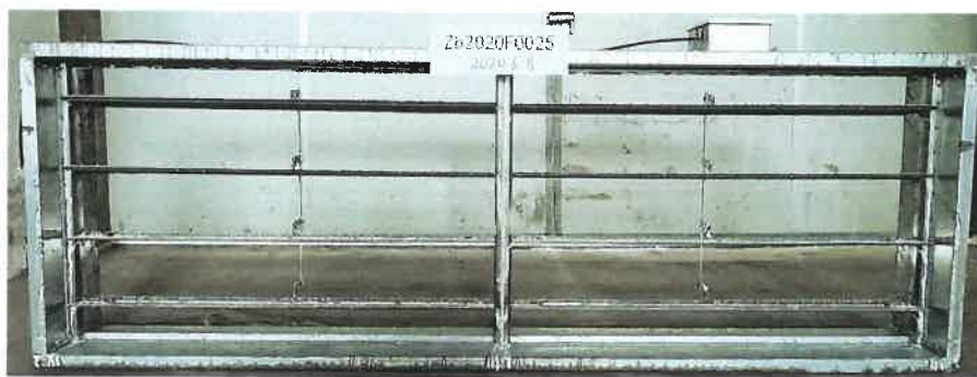
照片 1 耐腐蚀性试验后试件叶片打开状态
