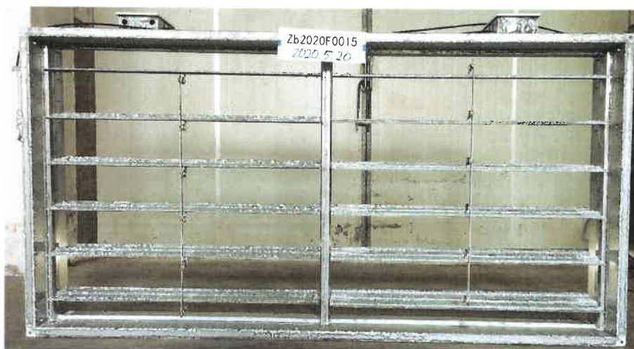
照片 1 耐腐蚀性试验后试件叶片打开状态
