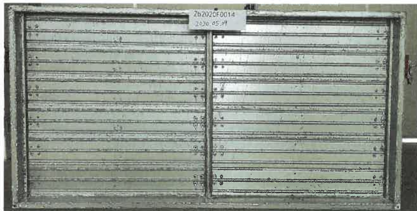
照片 2 耐腐蚀性试验后试件叶片关闭状态
