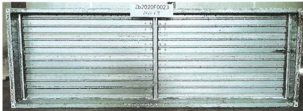
照片 1 耐火性能试验前试件情况
