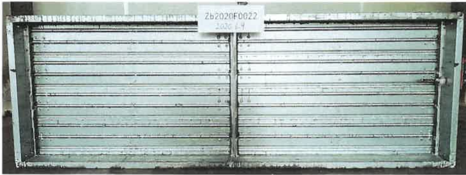
照片 1 耐火性能试验前试件情况
