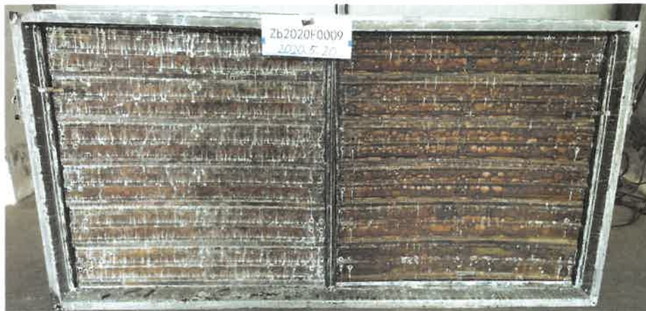
照片 2 耐火性能试验结束时试件情况
