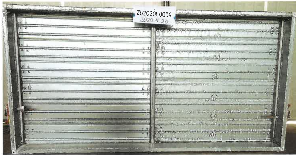
照片 1 耐火性能试验前试件情况
