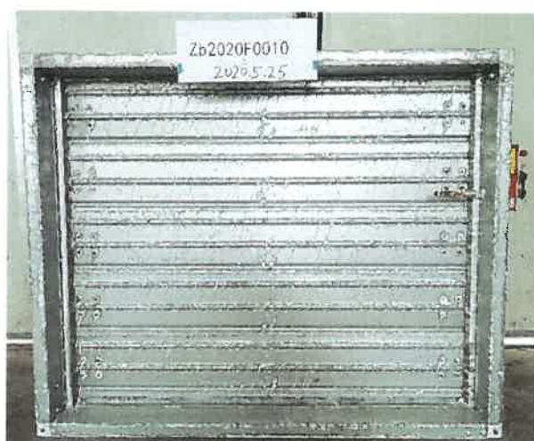
照片 1 耐火性能试验前试件情况
