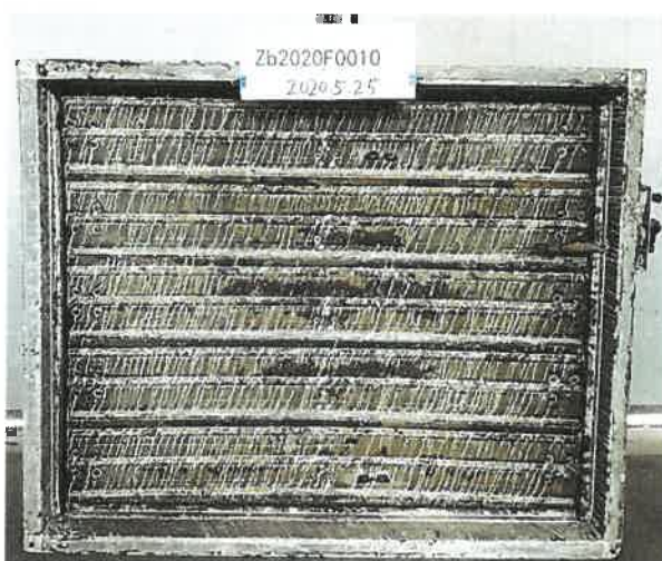
照片 2 耐火性能试验结束时试件情况
